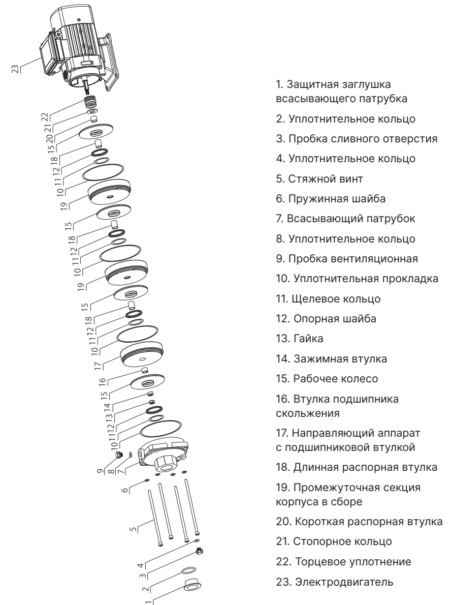
Рисунок – 6. Устройство насоса ВНР
